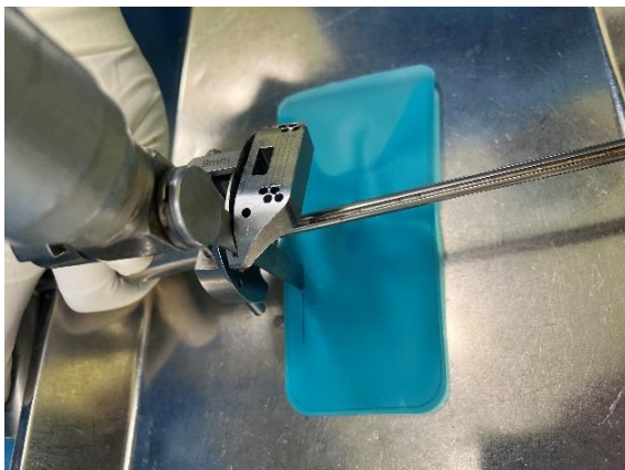
شکل ۲: تاثیر گشادی شیار برش بر میزان برداشت استخوان
