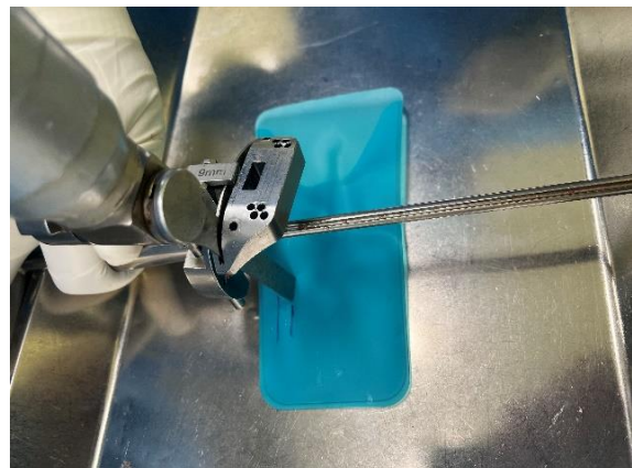
شکل ۲: تاثیر گشادی شیار برش بر میزان برداشت استخوان
