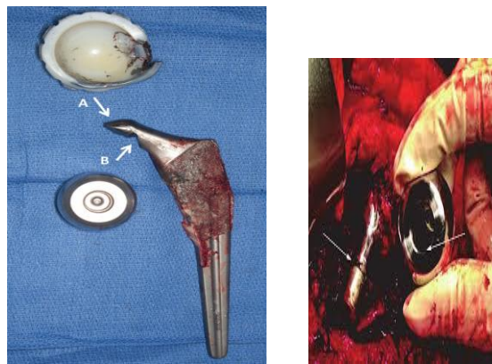
شکل ۱۱- تیپروسیس به طور کاملاً مشهود در فصل مشترک ناحیه اتصال هد با استم دیده می‌شود
