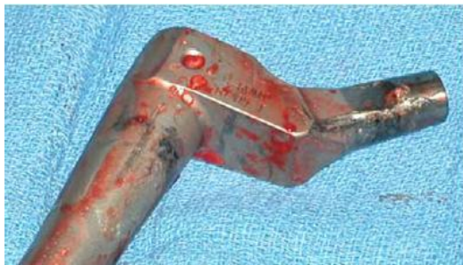
شکل ۱۲- تیپروسیس در آنالیزهای استم‌های خارج شده در دو ناحیه اتصال در گردن و سر بسیار چشمگیر و خطرناک گزارش شده است.
