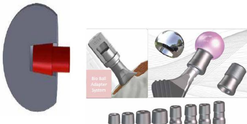
شکل ۱- نمونه‌های ناحیه تماس مخروطی استم با هد (نواحی تیپری) به صورت شماتیک
