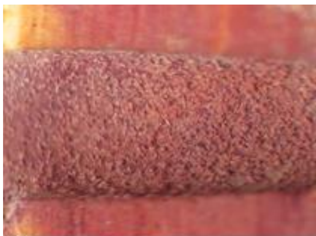
شکل ۵-D. عیوب سطحی: 60X ، N=2050\text{ rpm}
