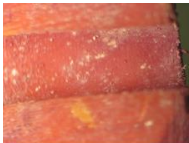
شکل ۵-A. عیوب سطحی: 60X ، N=1500\text{ rpm}
