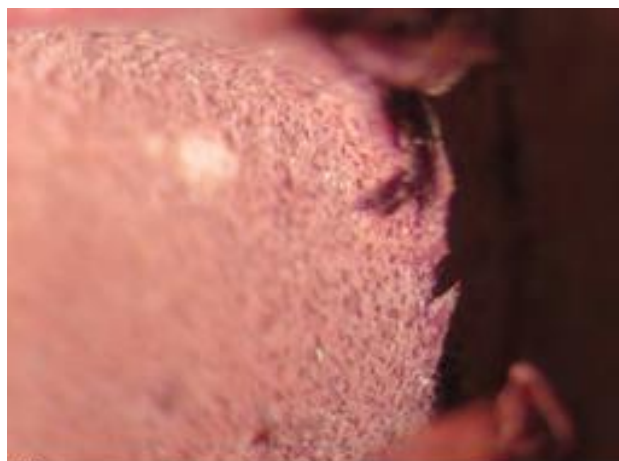
شکل ۶- A. عیوب سطحی: 60X , N=1500 rpm, با خنک کننده
