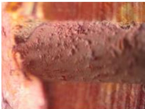
شکل ۵-C. عیوب سطحی: 60X ، N=1920\text{ rpm}
